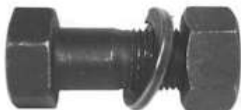
BULÓN DE CARDAN M12 X 1,25 X 34 CON ARANDELA GROWER Y TUERCA M12 X 1.25,LLAVE 19MM
