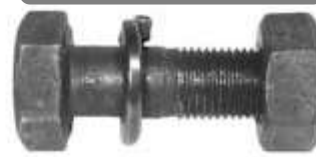
BULÓN DE CARDAN M10 X 1,0 X 35 CON ARANDELA GROWER Y TUERCA M10 X 1.0,LLAVE 17MM
